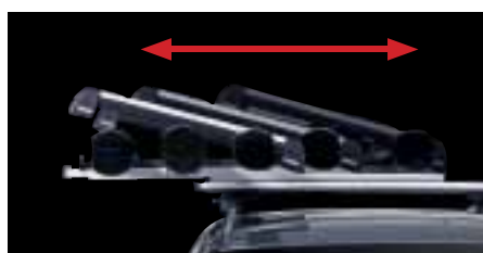
Выдвигается Легко выдвигается в сторону, позволяя загружать и разгружать лыжи и не тянуться при этом через автомобиль.
